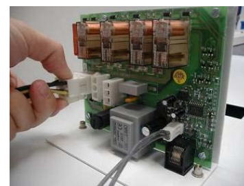
Desconecte los dos conectores de la placa de potencia apretando sobre la lengüeta.
