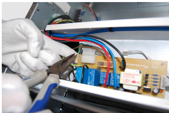
4. Desenganchar la PCB de los separadores utilizando una herramienta.
