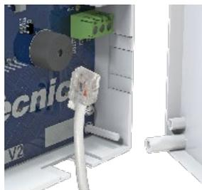
La carcasa principal tiene zonas de rotura de dos tamaños diferentes, dos situadas a cada lado y una en la parte inferior.
